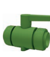
G 8852 PP-R Kugelhahn verschraubt Runddichtring-EPDM 20°C/1.0MPa grün PP-R Ball valve with union-nuts O-Ring-gasket-EPDM 20°C/1.0MPa green
